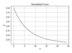
重み関数として静脈内瞬時投与の推移を  $y = exp(-0.1 \cdot t) + exp(-0.2 \cdot t)$ 、すなわちラプラス変換形で  $\tilde{y} = 1/(s+0.1) + 1/(s+0.2)$  と定義した(左図)。次に入力関数として、点滴投与(中段図)を想定した矩形関数入力( $\tilde{f}(s) = \{1 - exp(-a \cdot s)\}/s$ )、経口投与(下段図)を想定した指数関数入力を定義し、重み関数と掛け合わせることにより出力関数を得た。プログラムに定義したラプラス変換式の部分を図内に示す。なお、ラプラス変換はモデルに線形仮定が必要である(飽和のある薬
